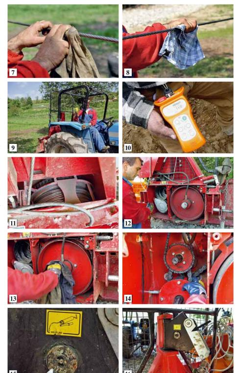
Approfittate di questo momento per controllare lo stato di tensione delle diverse catene che non devono essere né troppo serrate né «avere troppo gioco» (14).
